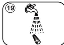
Antes e após a utilização da lavadora, proceda a limpeza do filtro de água (E):
